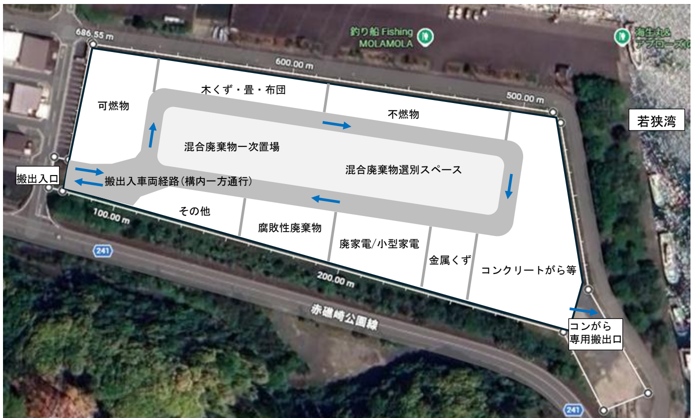
図 3-2 一次仮置場の配置例（大島南浦漁港多目的利用施設用地、区画分けは現状の災害廃棄物の搬入状況により適宜変更すること）
