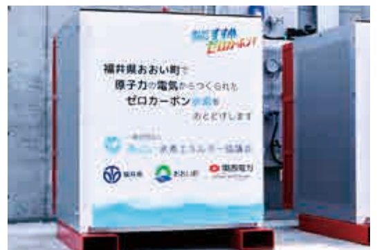
【製造した水素はカードルに保管されます】
